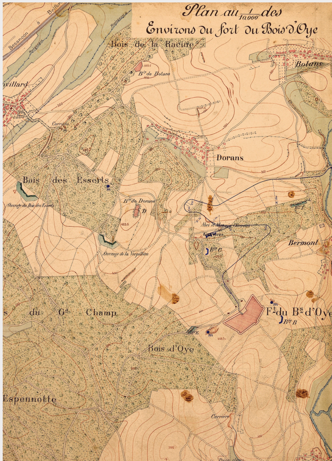
20 Plan des environs du fort du Bois d'Oye vers 1890. Tous les éléments de la fortification des années 1890 sont présents : chemin de fer militaire, magasins à poudre des batteries marqués « m », trois batteries nommées B, C et E et abris-cavernes (ADTB 15 J 2/20).
