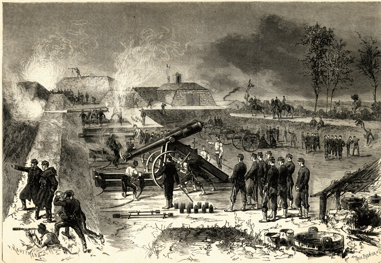
L'ARMÉE. — Belfort. — Essai des anciennes pièces de siège transformées se chargeant par la culasse. — (D'après nature, par M. Kauffmann.)
